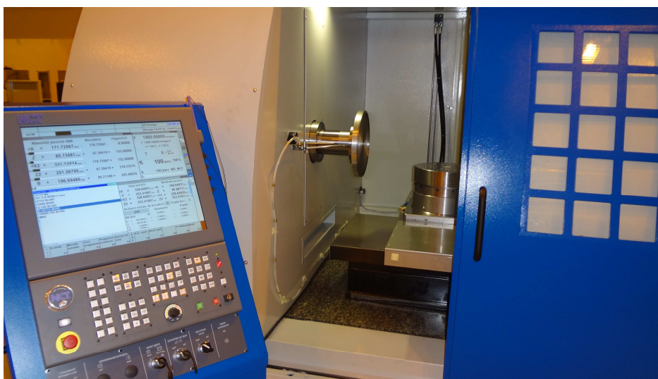
CNC vezérlés, mérőrendszer 0,1 mikron felbontással.
